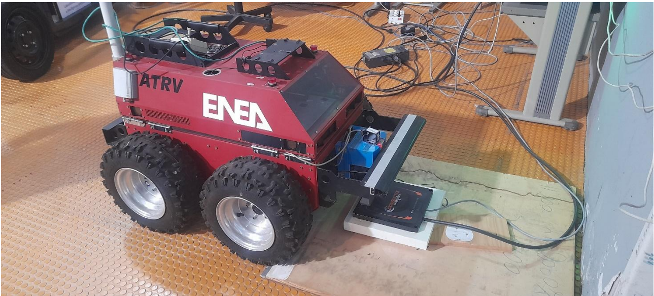
Figura 5 - Il robot PRASSI equipaggiato con il sistema induttivo. Visibile a terra una delle due piastre per l'induzione
