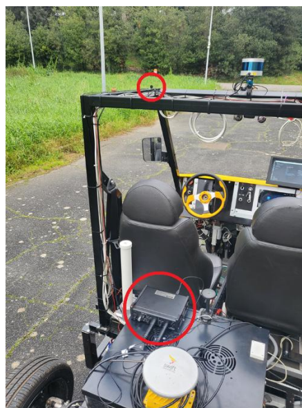
Figura 1 - Il prototipo realizzato installato sul veicolo elettrico. Nel cerchio rosso in alto uno dei microfoni, in quello in basso la scheda di acquisizione audio
