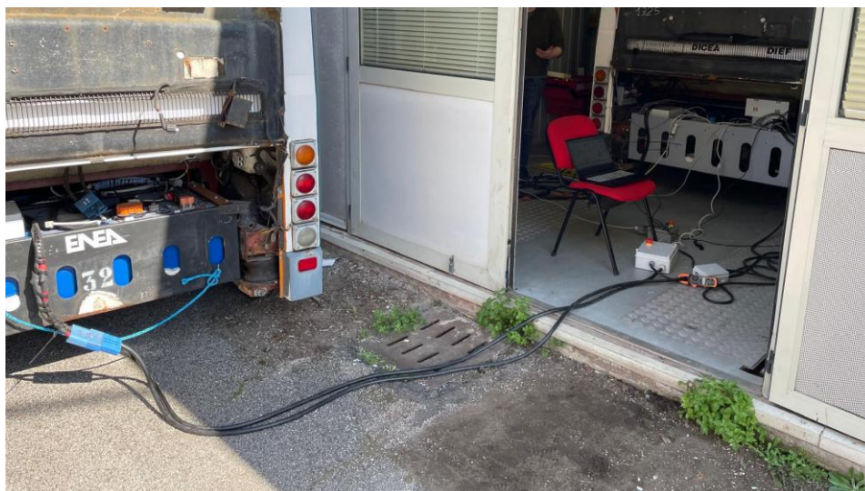
Figura 8 - Cavi di collegamento tra i due autobus. L'autobus master è sul banco a rulli, mentre l'autobus slave è fermo all'esterno del fabbricato.
