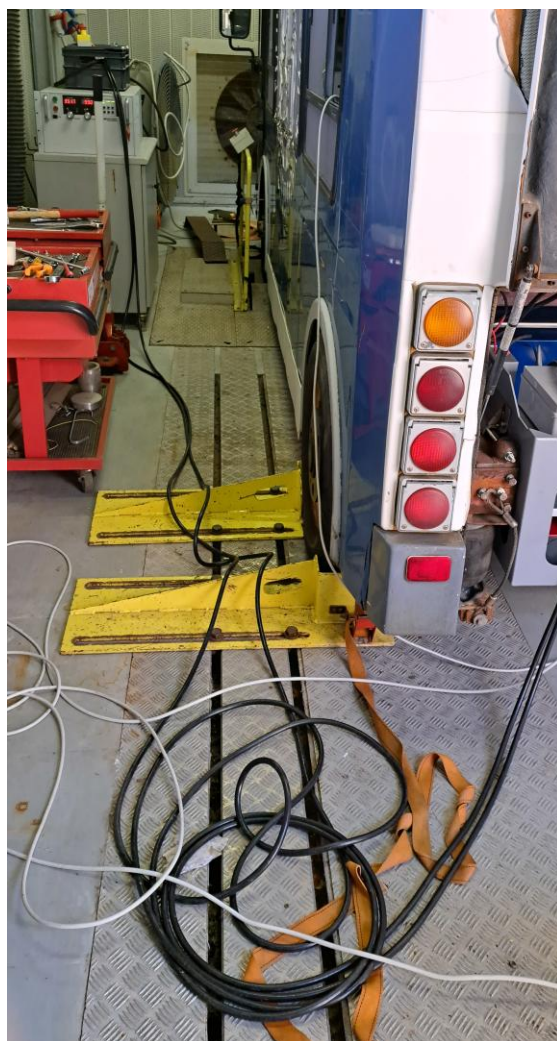
Figura 7: Caricatore usato per simulare la captazione da catenaria (sinistra)
