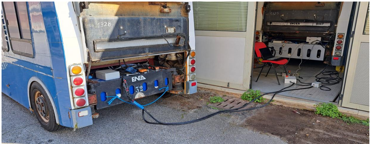
Figura 8: Collegamento fra i due veicoli per consentire lo scambio di carica
