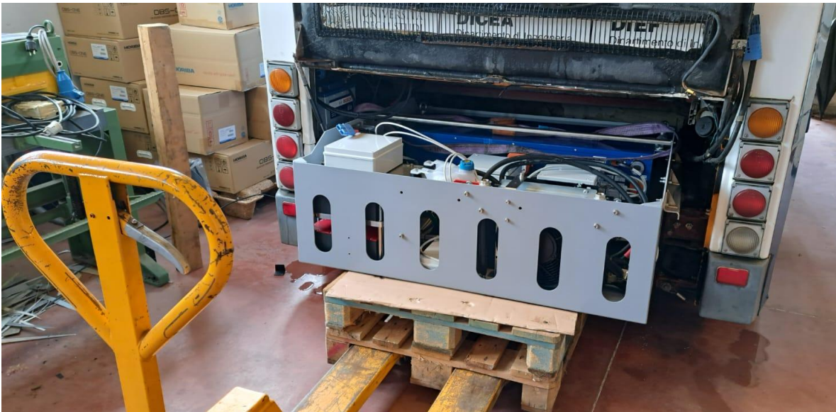
Figura 5 - Installazione del cassone a bordo di uno dei due autobus
