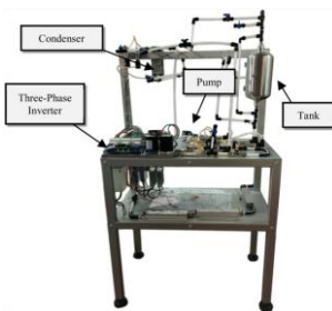
Banco prova per raffreddamento bifase
