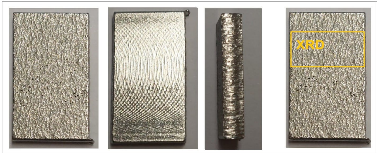
Figura 24 - Foto del provino AISI 347H - Area di analisi
