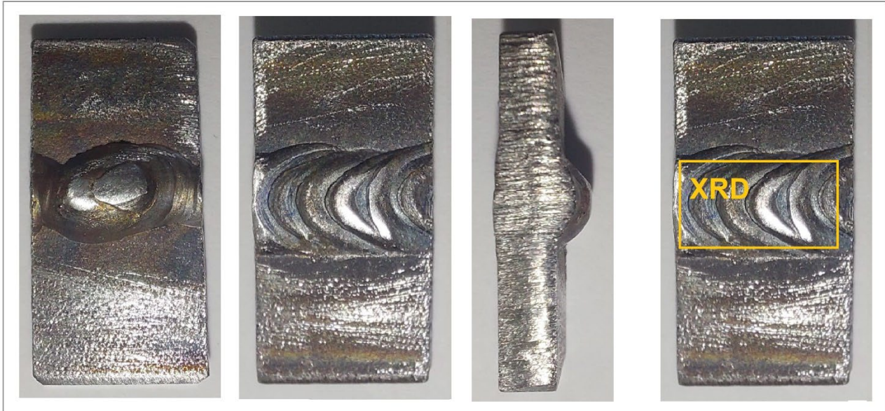
Figura 21 - Foto del provino AISI 304 saldato - Area di analisi
