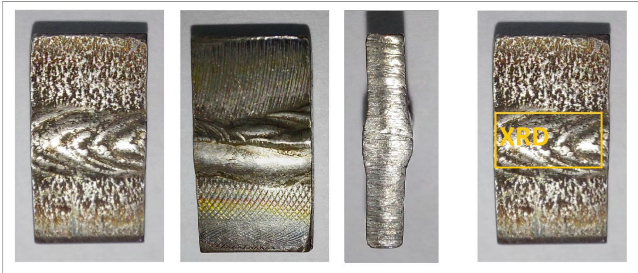
Figura 27 - Foto del provino AISI 347H Saldato - Area di analisi
