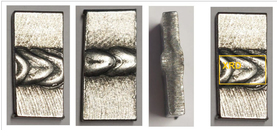
Figura 33 - Foto del provino Acciaio al C A516Gr.70 (P355NH) saldato - Area di analisi
