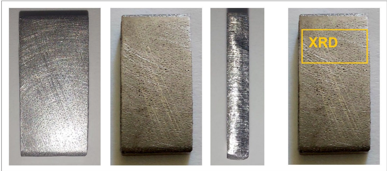
Figura 18. Foto del provino AISI 304 - Area di analisi
