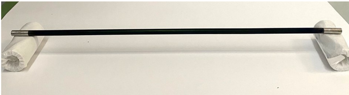
Figura 4 – Prototipo di coating per tubo ricevitore evacuato dell'impianti micro-CSP di tipo micro-PTC dell'Università degli Studi di Firenze per applicazioni fino a 350 °C
