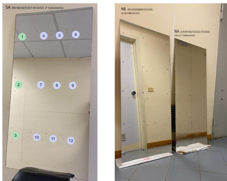
Figura 4 – Specchio solare SA: Definizione dei punti di misura periodici.
