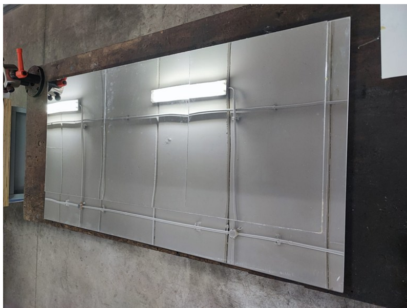
Figura 1 - Incollaggio degli specchi in officina meccanica.
