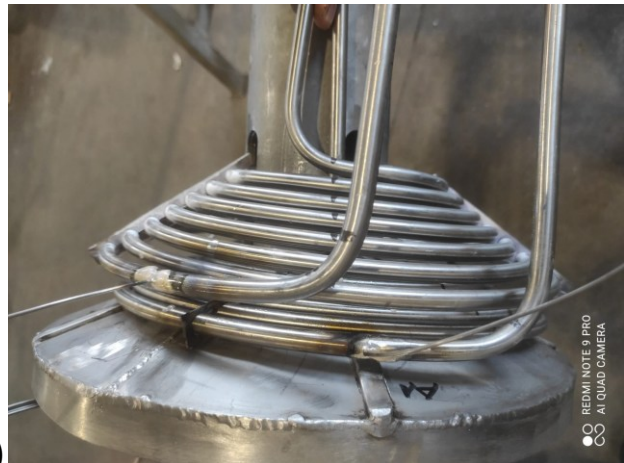
Figura 5 – a) Tubi dello scambiatore avvolti a spirale b) assemblaggio dei tubi dello scambiatore
