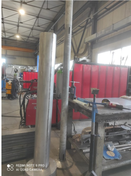
Figura 4 – Realizzazione del canale centrale dello scambiatore di carica
