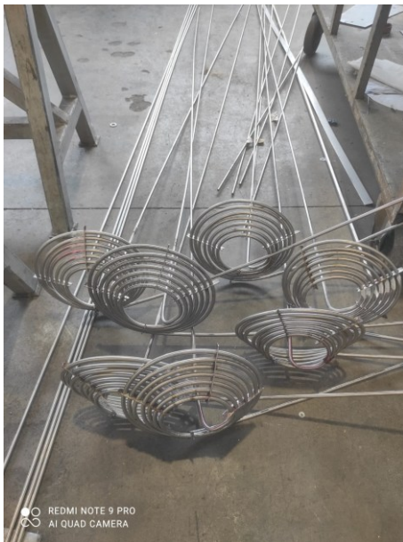
Figura 5 – a) Tubi dello scambiatore avvolti a spirale b) assemblaggio dei tubi dello scambiatore
