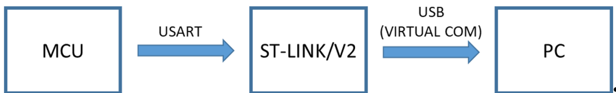
Fig.12. Schema funzionale dell'interfaccia di debug.
