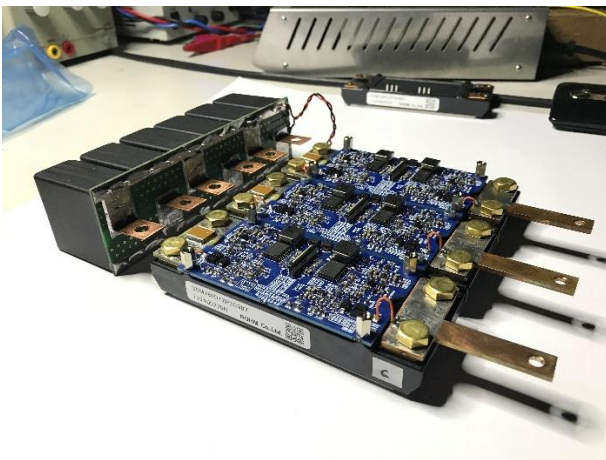
Fig.4. Moduli di potenza (SiC MOSFETs in configurazione half bridge) con scheda driver custom che integra il sistema per la misura della tensione di conduzione dei device.
