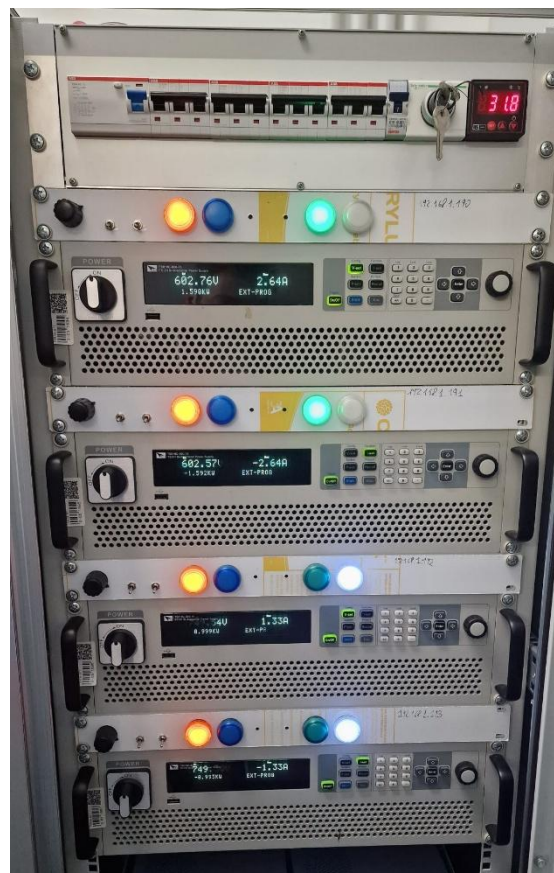
Figura 3: Carichi elettronici CC ITECH IT6018C-800-75
