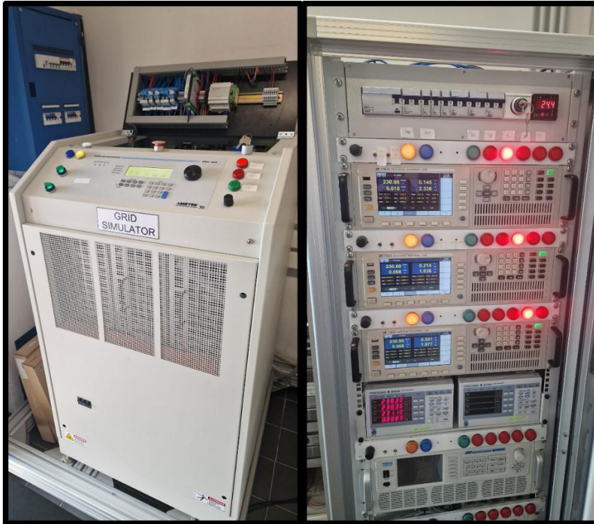
Figura 2: Simulatore di rete trifase MX30 e carichi elettronici AC ITECH IT8615
