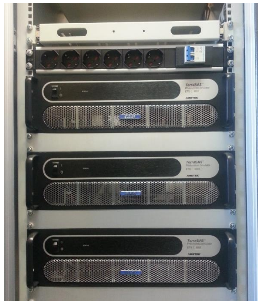
Figura 50: Simulatori di array fotovoltaici
