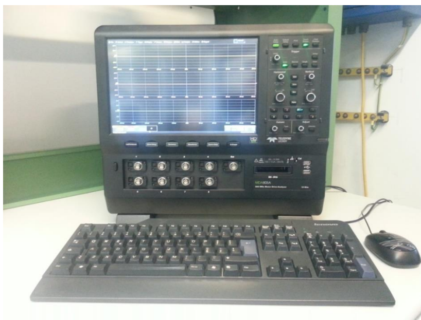
Figura 63: Oscilloscopio digitale 8 canali LeCroy modello MDA805A
