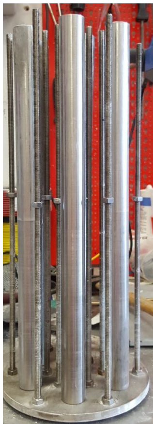
Figura 16: Supporto in acciaio del dispositivo filtrante, realizzato da ENEA su nostro progetto
