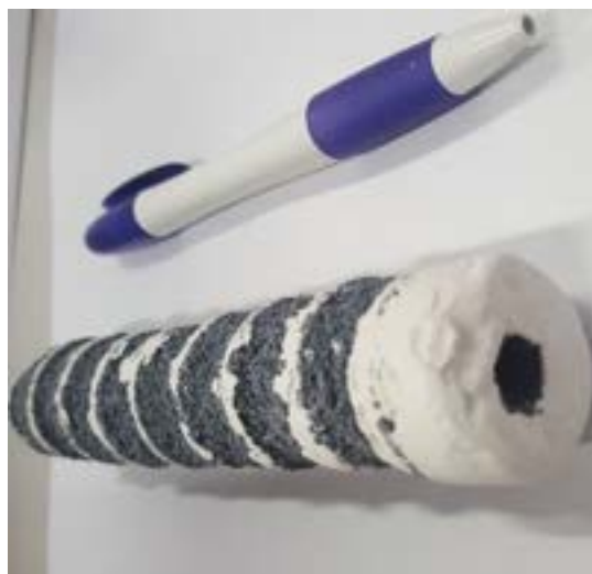
Figura 4. Filtro realizzato con la schiuma ceramica in SiC e allumina da 65 ppi
