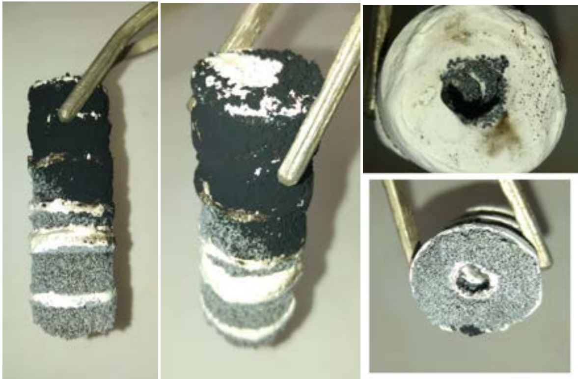
Figura 24. Secondo filtro a schiume ceramiche a media porosità al termine delle prove
