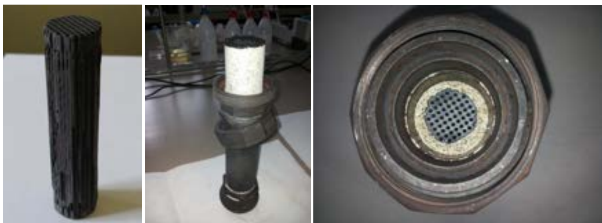
Figura 25. Filtro wall flow (a sinistra), portafiltro e materassino intumescente (in centro) e vista dall'alto del filtro inserito nel portafiltro (a destra)
