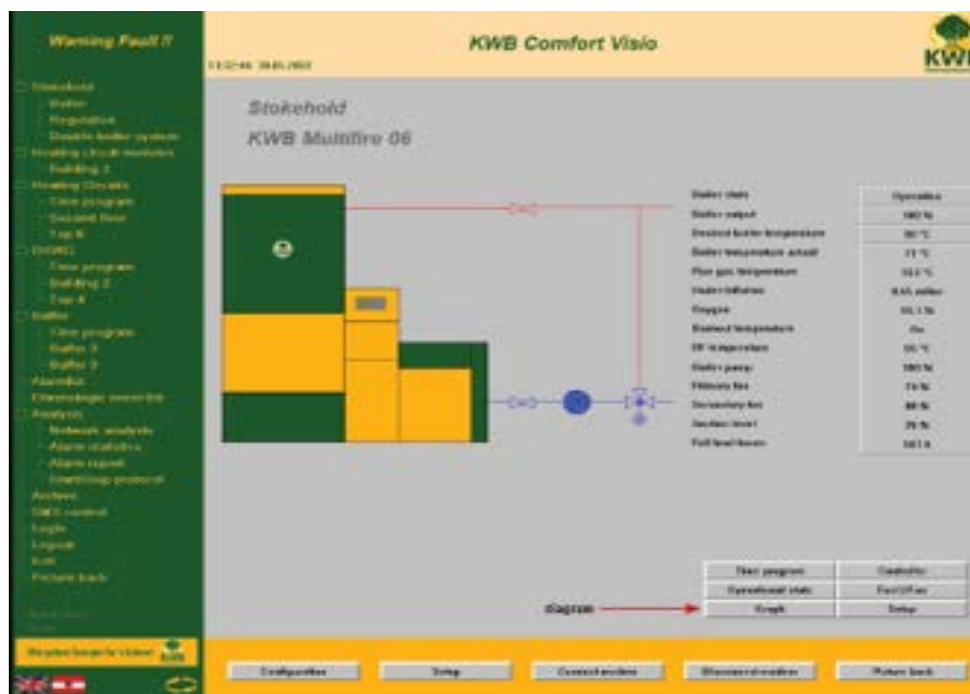
Figura 4. Interfaccia grafica del software di monitoraggio della caldaia
