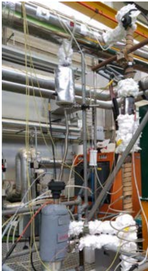
Figura 2. Linea prova filtri con impattore (collegato alla canna fumaria) e contaparticelle PPS (a valle del filtro)
