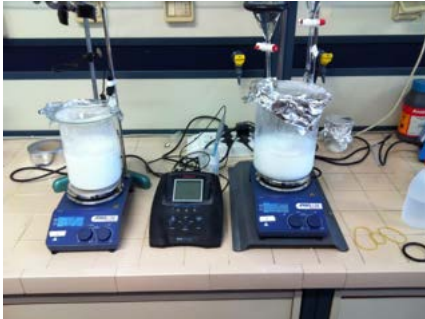
Figura 9. Sintesi di idrotalcite a pH costante
