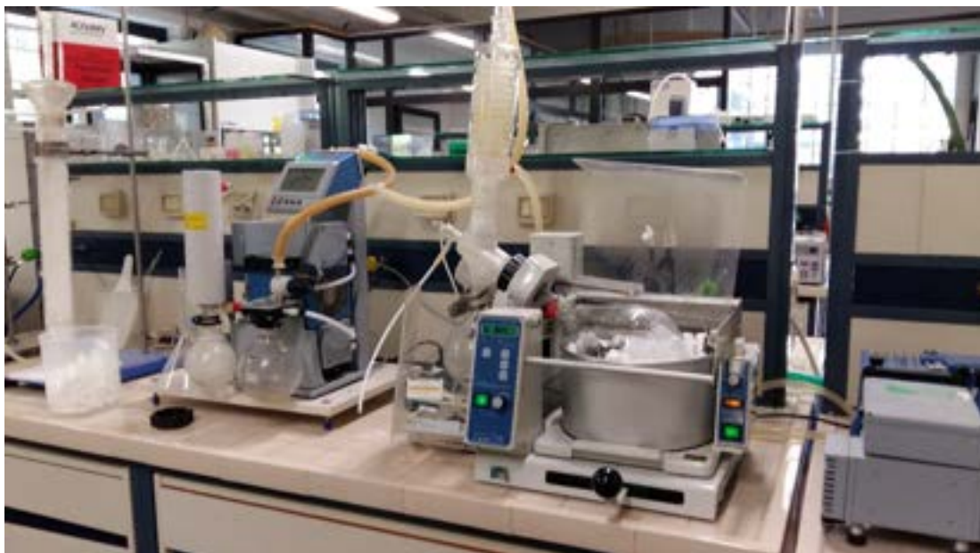
Figura 11. Wet impregnation in rotavapor
