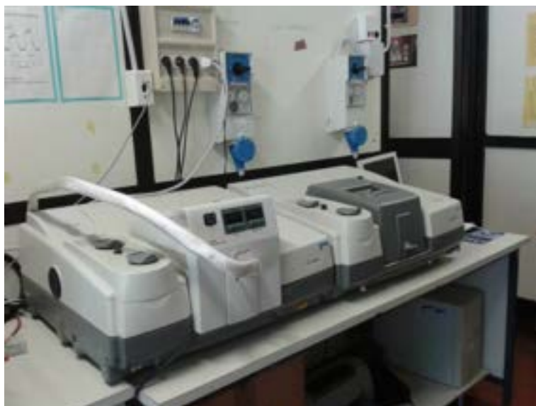
Figura 14. Spettrofotometro ad Infrarosso Nexus Thermo Nicolet
