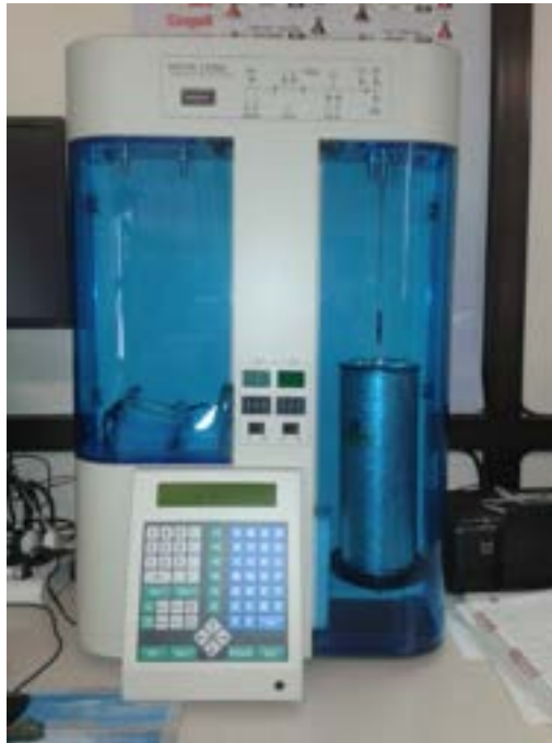
Figura 17. Porosimetro ad azoto mod. Nova 1220e Alfatest
