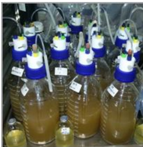
Figura 11. Allestimento della II Serie Sperimentale usando reattori da 1,2 L con tappo a tre vie: i reattori sono stati posti nel termostato, a 37 °C e al buio
