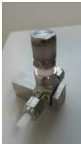
Fig. 2.1.5 - Il diffusore di gas a filtro
