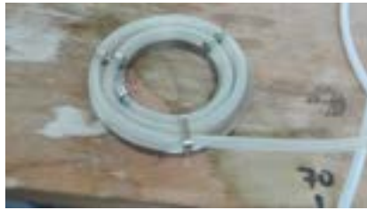
Fig. 2.1.6 - Il diffusore di gas a spirale forata
