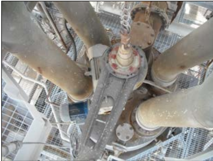
Figura 28. Motori di rotazione e traslazione dello stirrer.
