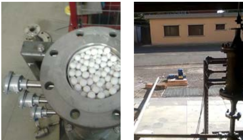
Figura 18. Immagine del riempimento in alluminia del reattore e del set up allestito
