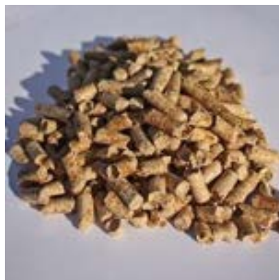
Figura 9. Pellet di pino utilizzato nel test di gassificazione
