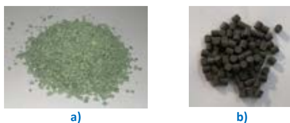
Figura 6. Catalizzatori di metanazione utilizzati nei test con gas reale: a) catalizzatore sperimentale Ni 23,7 Mg 56,3 Al 20 ; b) commerciale
