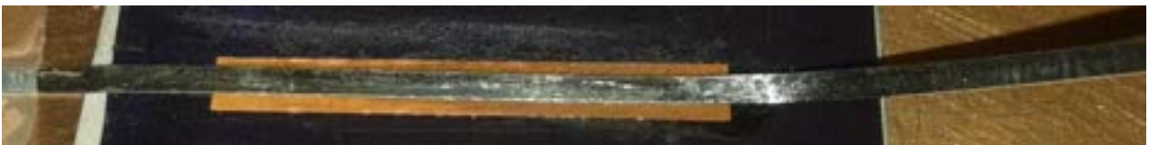
Figura 27: Campione per peel test
