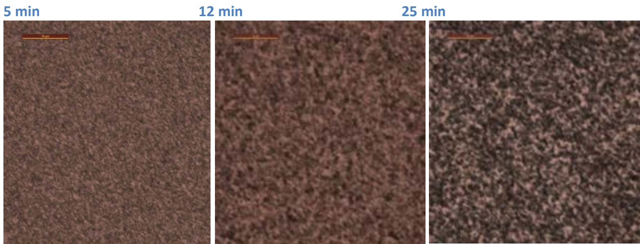
Figura 21. Immagini al microscopio ottico della superficie di wafer dopo trattamento RIE di differente durata.
