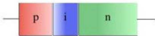
Figura 2.4.1.a: Struttura del diodo PiN
