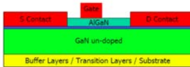
Figura 2.4.5.a: Sezione di un HEMT in tecnologia GaN
