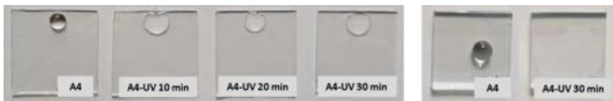
Figura 13. Fotografie di film \text{TiO}_2 -acac (A4) depositati su vetro (sinistra) e FTO (destra), prima e dopo irradiazione UV, con una goccia d'acqua che mostra la variazione dell'angolo di contatto con la superficie.
