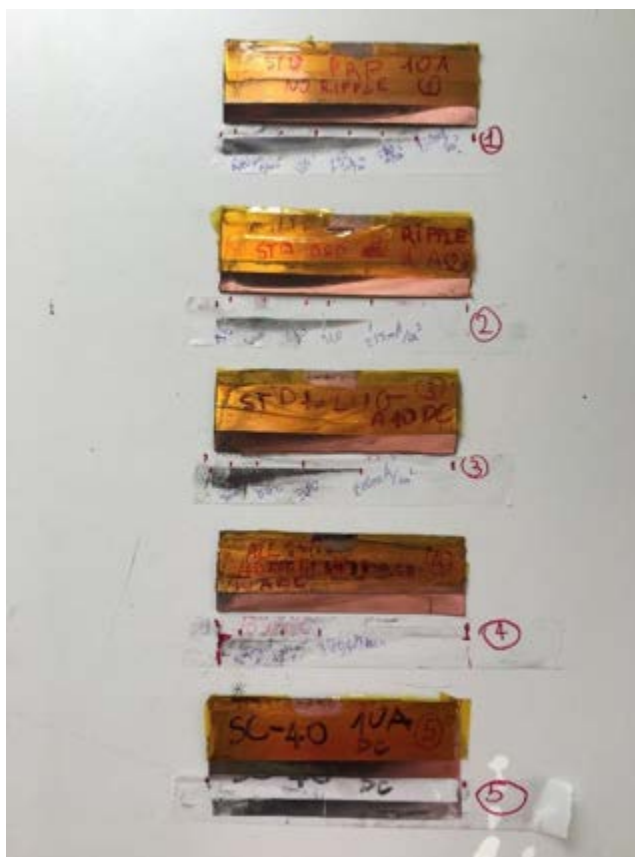
Figura 11. Campioni Rame depositato su substrato di ottone in cella di Hull. La densità di corrente varia tra 50 mA/cm 2 (sulla parte destra di ogni campione) a 10 A/cm 2 (parte sinistra di ogni campione). Dall'alto verso il basso: (1) soluzione (220 g/L di Cu 2 SO 4 5H 2 O, 55g/L di H 2 SO 4 = 55 g/L) senza additivi depositata in PRP; (2) soluzione(220 g/L di Cu 2 SO 4 5H 2 O, 55g/L di H 2 SO 4 = 55 g/L) senza additivi depositata sotto regime PRP con sovrapposizione di un "ripple" di tensione in fase catodica; (3) soluzione (220 g/L di Cu 2 SO 4 5H 2 O, 55g/L di H 2 SO 4 = 55 g/L) con aggiunta dell'additivo BASF Lugalvan P depositato in corrente continua; (4) soluzione (Cu 2 SO 4 5H 2 O = 250g/L, H 2 SO 4 = 60 g/L) con l'aggiunta di additivi (ione cloruro = 50 ppm, tiourea = 20 mg/L, blu di metilene = 10 mg/L, giano verde = 10 mg/L, sodio dodecil solfato = 20 mg/L, additivo BASF Lugalvan P = 0.2 wt%); (5) soluzione commerciale SC-40( Enthone). Sotto ogni campione è presentato lo scotch test eseguito sui campioni stessi.
