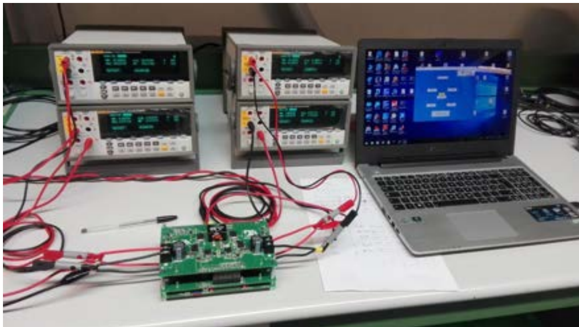
Figura 32. Caratterizzazione sperimentale del prototipo di convertitore SMPPT con MOSFET in Si
