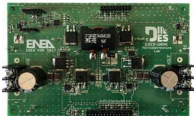
Figura 38. Top view dalla scheda di potenza in Silicio.
