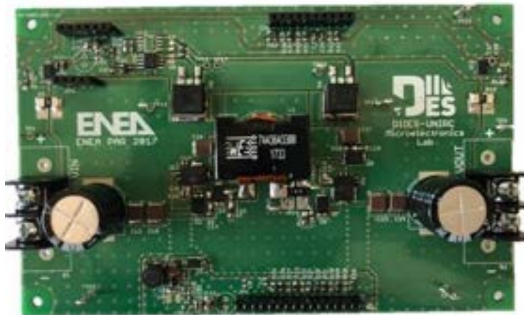
Figura 40. Top view dalla scheda di potenza in Nitruro di Gallio.
