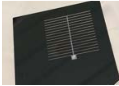
Figura 6. Fotografia dei dispositivi realizzati sul wafer completi di griglia frontale in Al per la raccolta della corrente
