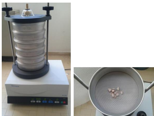
Figura 6. Vibrovagliatore e frazioni di campione dopo vagliatura
