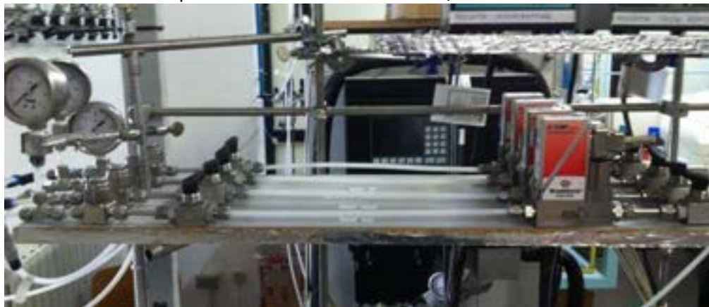
Figura 2.4-2 Linee di alimentazione gas di processo
