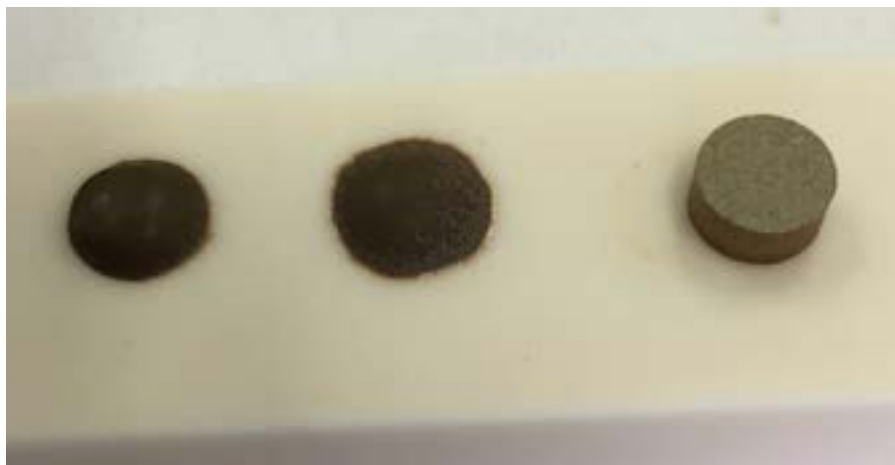
Figura 3.1-7 A sinistra due pasticche zeolite fuse rispetto alla mullite, trattamento termico 1400°C
