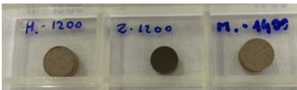
Figura 3.1-8 Pasticche di Mullite a 1200 °C (a sinistra), Zeolite a 1200 °C (al centro) e Mullite a 1400 °C (a destra)
