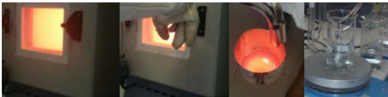
Figura 5 Procedura di fusione alcalina
