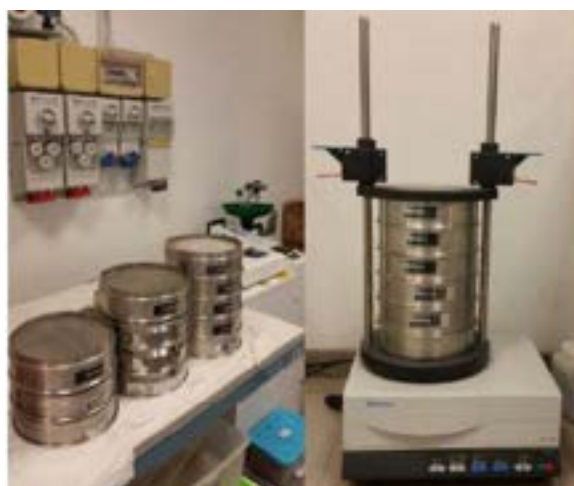
Figura 2. Esempio di setacci utilizzati per l'analisi granulometrica e vibrovaglio
