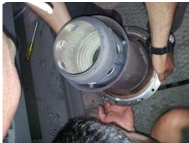
Figura 2. Il combustore Turbec durante la fase di estrazione dalla \mu GT di AGATUR
