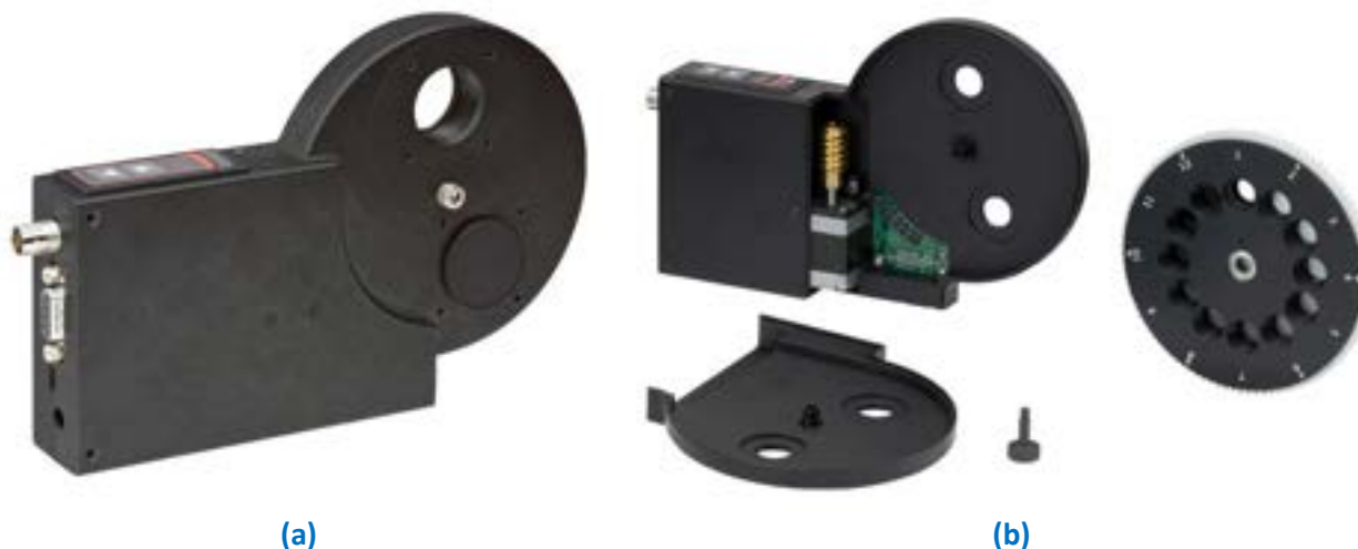
Fig. 8: Immagine della ruota porta-filtri come appare esternamente (a) e come è realizzata internamente (b).
