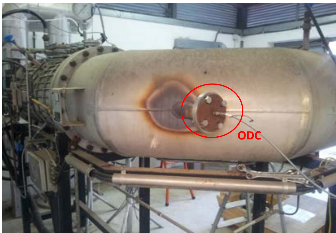
Fig. 18: Particolare del collegamento della testa ottica ODC alla flangia frontale.
