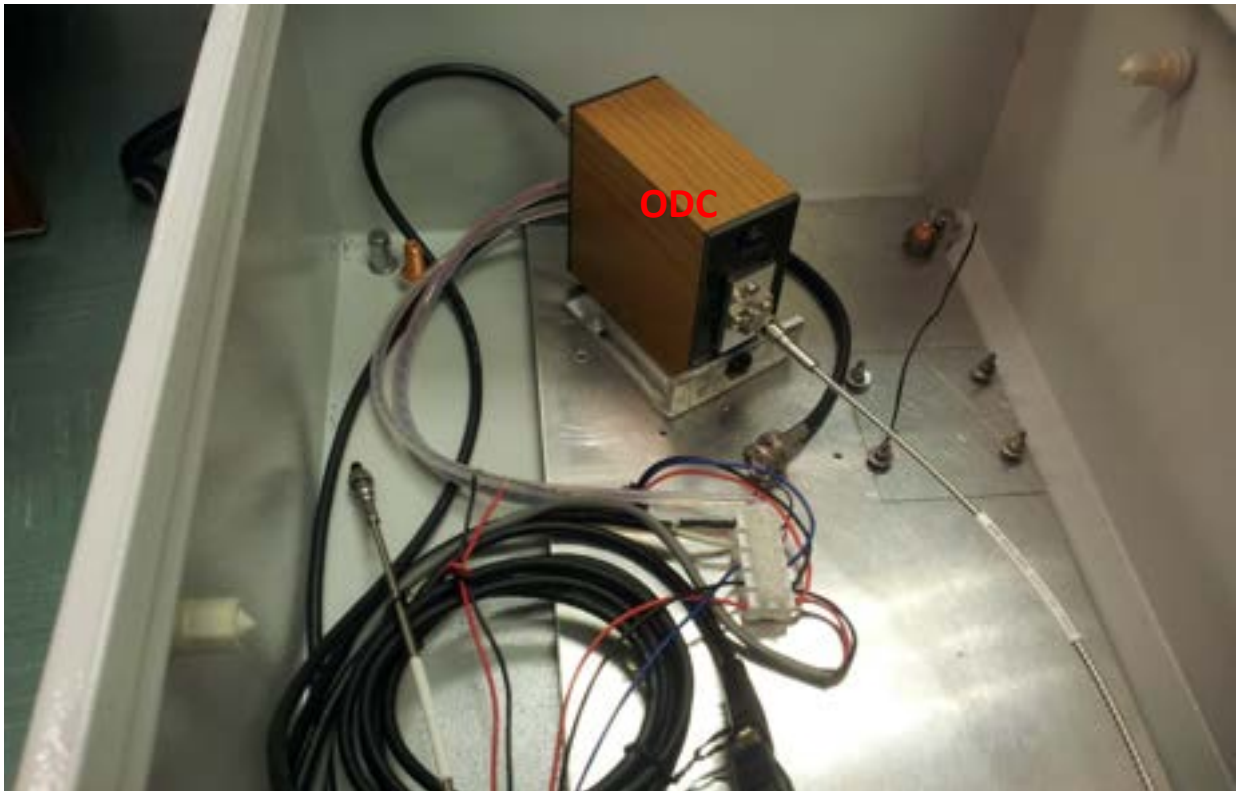
Fig. 6: Immagine del sensore ottico ODC posizionato all'interno della scatola ATEX.
