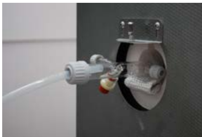
Figura 4.1. Sistema sperimentale: gas in ingresso al reattore
