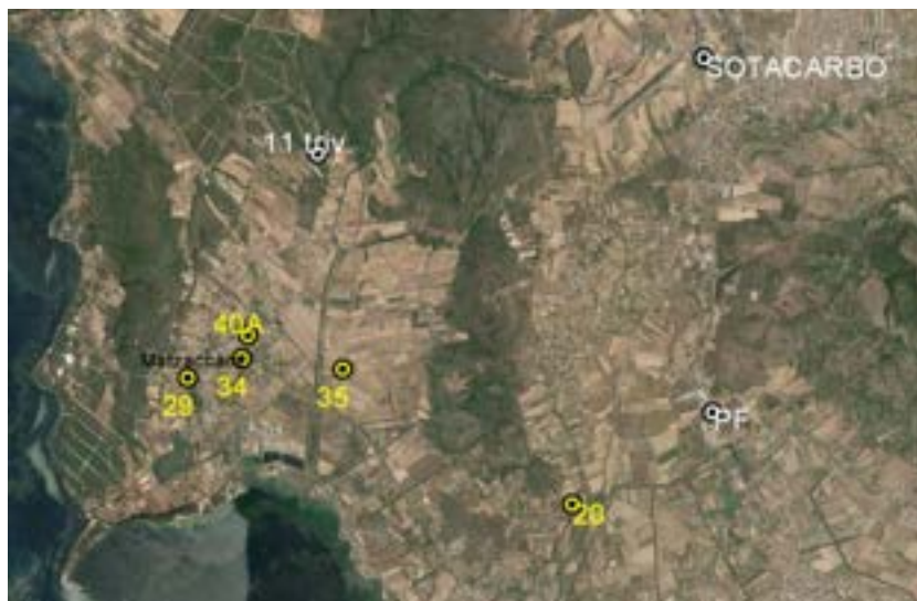
Figura 12. Posizione dei pozzi superficiali (in giallo) e profondi (in bianco) al cui interno sono collocate le sonde GasPro.
