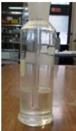
Figura 11. Drechsel contenente isopropanolo dopo gorgogliamento del syngas dalla linea di prelievo a freddo.
