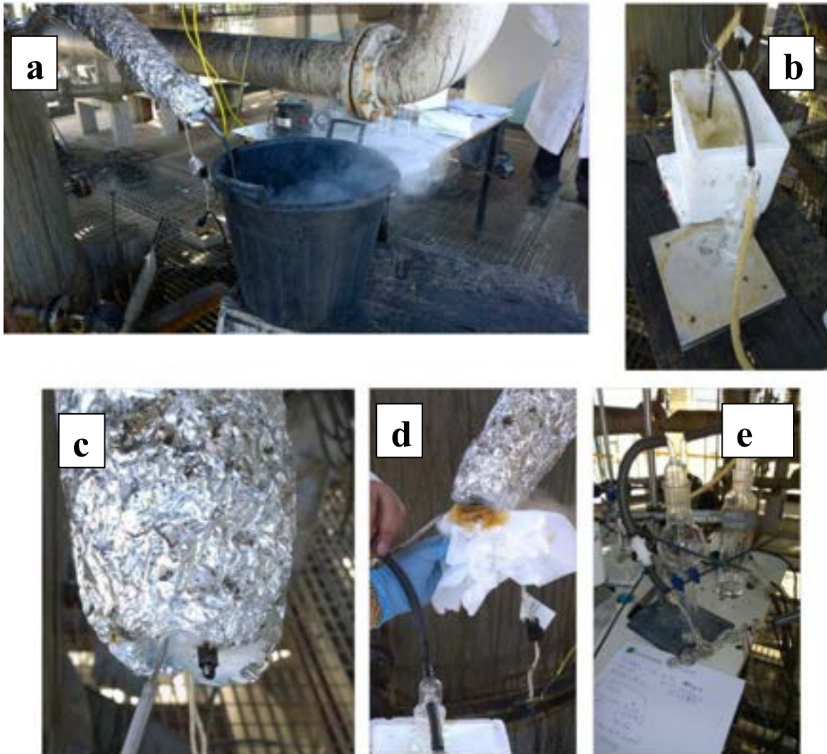
Figura 7b. Allestimento delle trappole e prelievo dei campioni relativi alla campagna del 27 luglio 2016: a. pulizia del punto di prelievo del TAR; b. prelievo del TAR; c-d. spurgo della linea di prelievo del TAR; e. valvola di prelievo.
