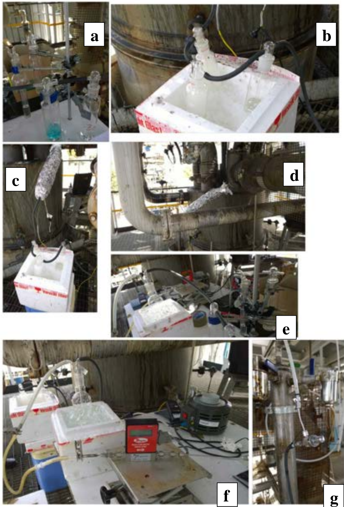
Figura 6. Allestimento delle trappole e prelievo dei campioni relativi alla campagna del 05 luglio 2016: a. particolare delle trappole per solfuri e umidità; b. Drechsel per la raccolta del tar; c. camicia termostatica per il prelievo del tar; d. vista della zona di campionamento; e. Trappola con ghiaccio per la condensazione dell'umidità prima dell'ingresso al totalizzatore di portata; f. raccolta del tar e misura del flusso; g. valvola a spillo per la regolazione della portata del gas.
