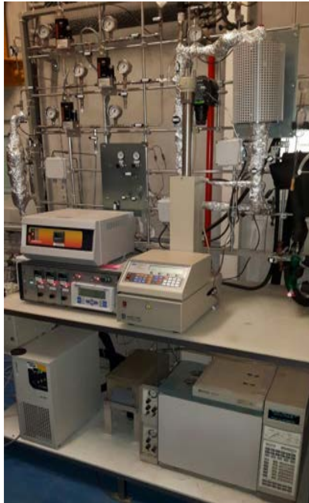
Figura 1.5. Impianto "SNG Low Pressure"
