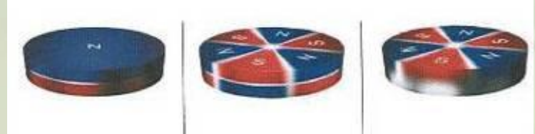
Esempi di geometrie di magnetizzazione
