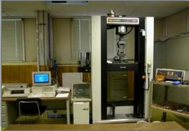
Macchina universale Instron Mod. 4507, cella da 150 kN
