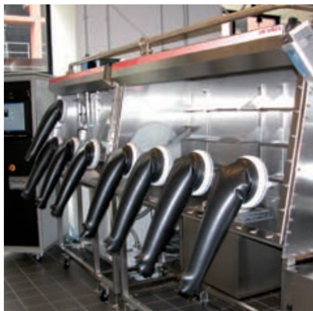
Glove Box per lo sviluppo di celle solari polimeriche in ambiente privo di umidità e ossigeno
