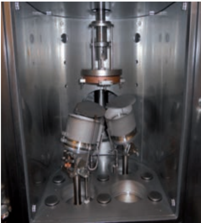
Impianto di sputtering per la deposizione di film sottili di metalli, ossidi conduttori o solfuri utilizzati nella fabbricazione di celle in \text{Cu}_2\text{ZnSnS}_4
