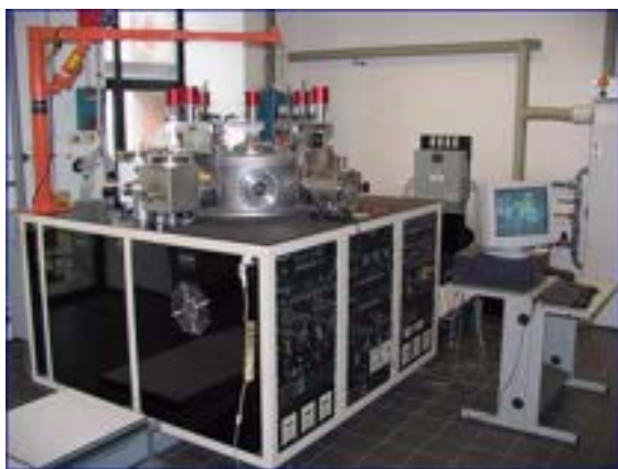
Impianto per la deposizione di film sottili di silicio con tecnica PECVD – VHF PECVD
