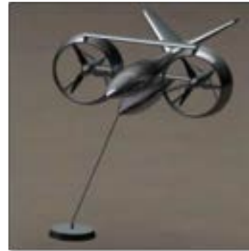
Dispositivo di conversione delle correnti di marea GEM
