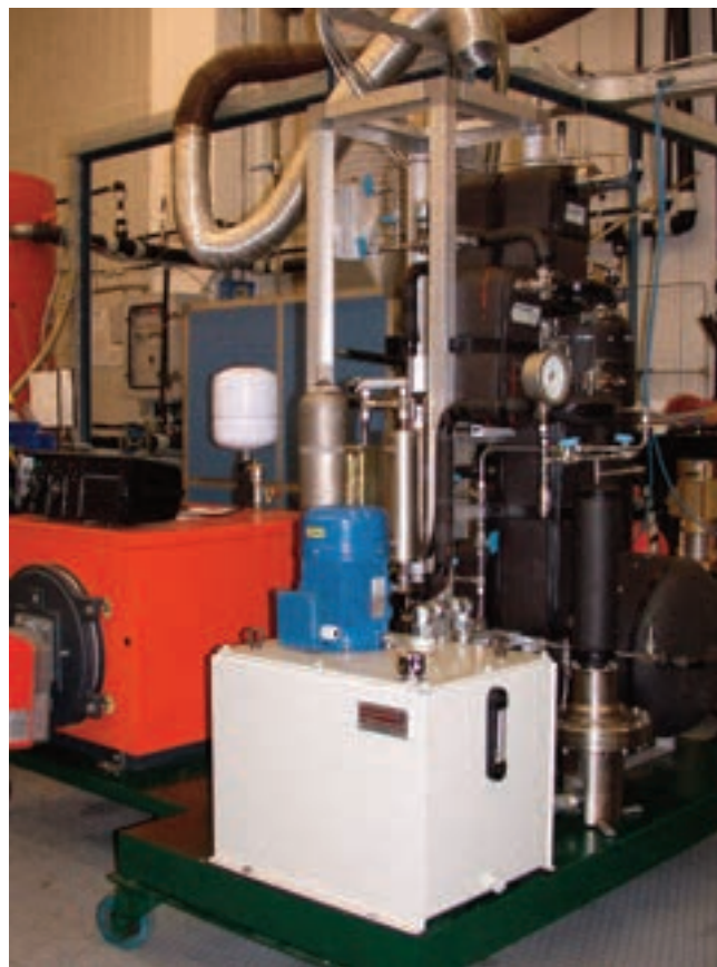
Facility per l'analisi sperimentale della pompa di calore ad assorbimento del tipo acqua-ammoniaca
