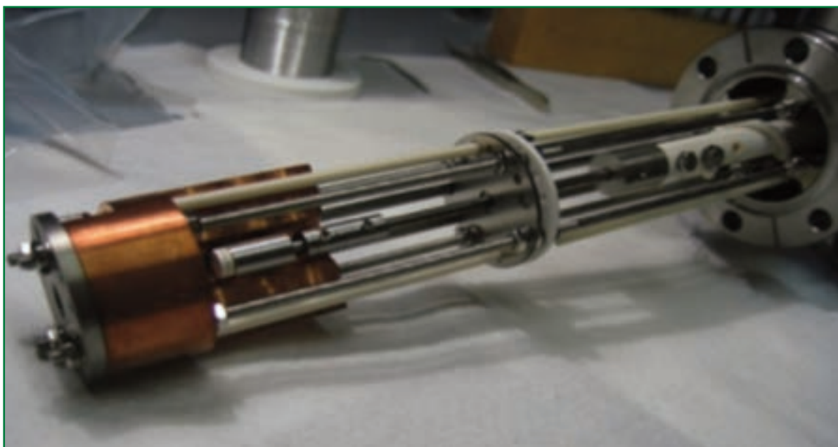
Evaporatore a bombardamento elettronico per la preparazione di anodi con ossido di silicio di celle al litio
