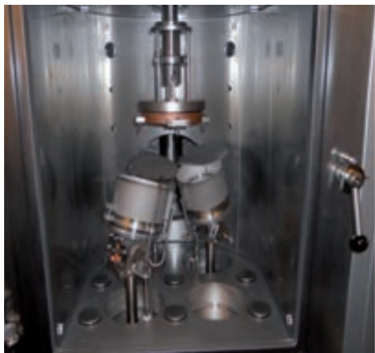
Impianti per il co-sputtering di solfuri binari (configurazione confocale, a sinistra) e per lo sputtering in linea di Mo, ZnO e ZnO:Al (configurazione planare, a destra)
