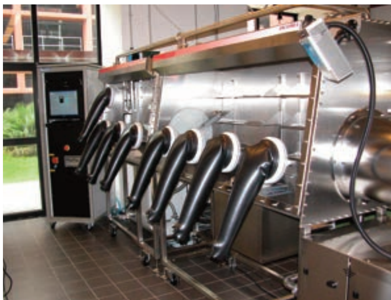
Glove Box per lo sviluppo di celle solari polimeriche in ambiente privo di umidità e ossigeno
