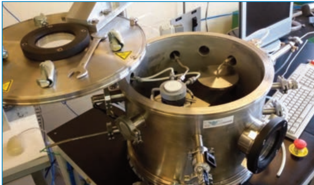
Nuovo forno di solforizzazione installato presso il Centro ENEA di Casaccia
