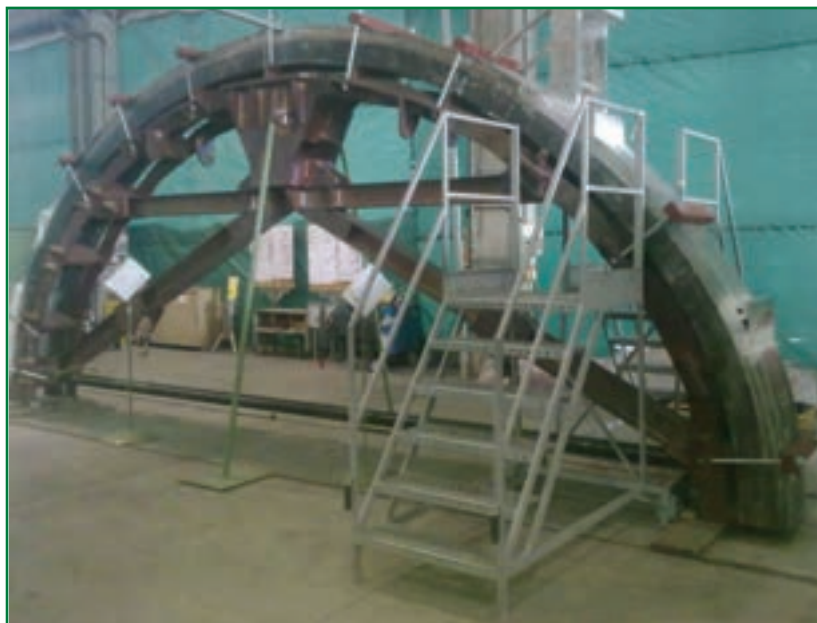
Gamba curva in fase di saldatura degli accessori esterni
