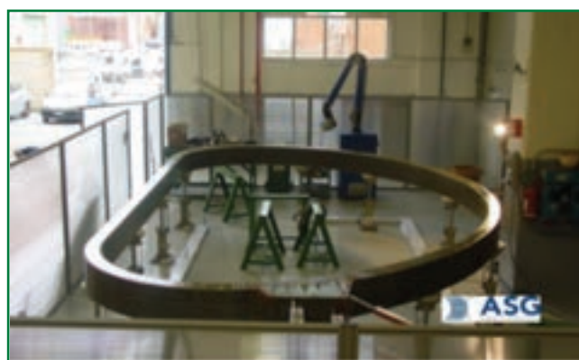
Assieme della prima bobina al termine delle operazioni di impilaggio dei 6 DP e dopo la rimozione del lamierino per impregnazione
