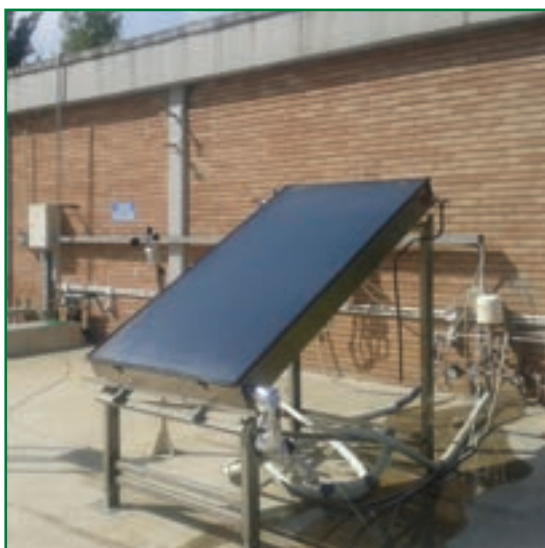
Prototipo collettore solare termico: test preliminari
