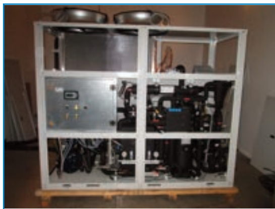
Prototipo PDC ad R744 reversibile (caldo/freddo) dotato di un eiettore: potenzialità 30 kW
