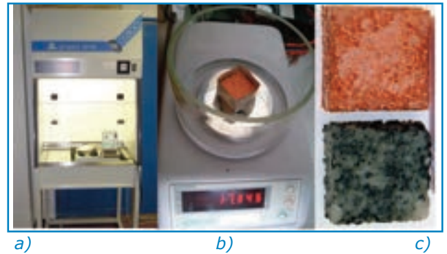
a) Cappa con all'interno il bagno termostato; b) blocchetto di schiuma nel contenitore in "coffee bag"; c) blocchetti di schiuma riempiti di PCM: in alto Cu-10, in basso SiC
