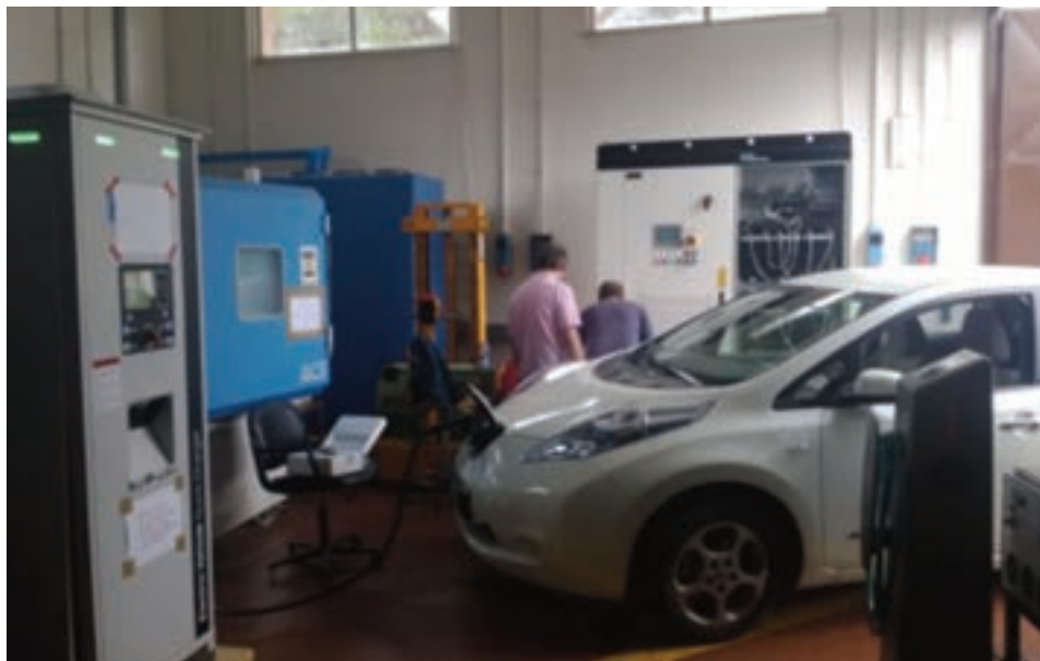
Test al banco del prototipo di caricabatterie integrale e apparato sperimentale stazione di ricarica combinata
