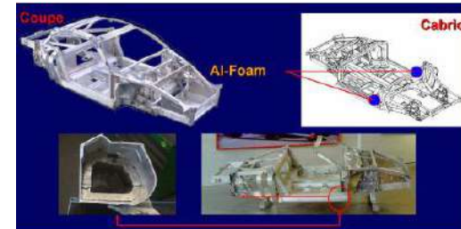
Ferrari F430 Spider irrigidimento con profilati riempiti con schiuma
